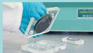
Nach der Zentrifugation die Form abkühlen lassen, auseinanderschrauben und fertiges Bauteil entnehmen
