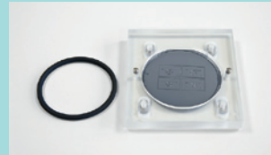
ZentriForm-Einsatz montieren: Master und O-Ring einlegen und Form verschrauben
