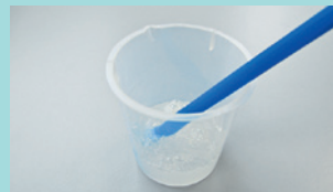
Silikon anrühren und in die Einsätze füllen
