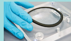
Nach der Zentrifugation die Form abkühlen lassen, auseinanderschrauben und fertiges Bauteil entnehmen
