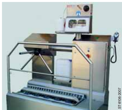
Bild 8: Zugangskontrolle zum Arbeitsplatz in der Produktion mit integrierter Atemprobenahme
