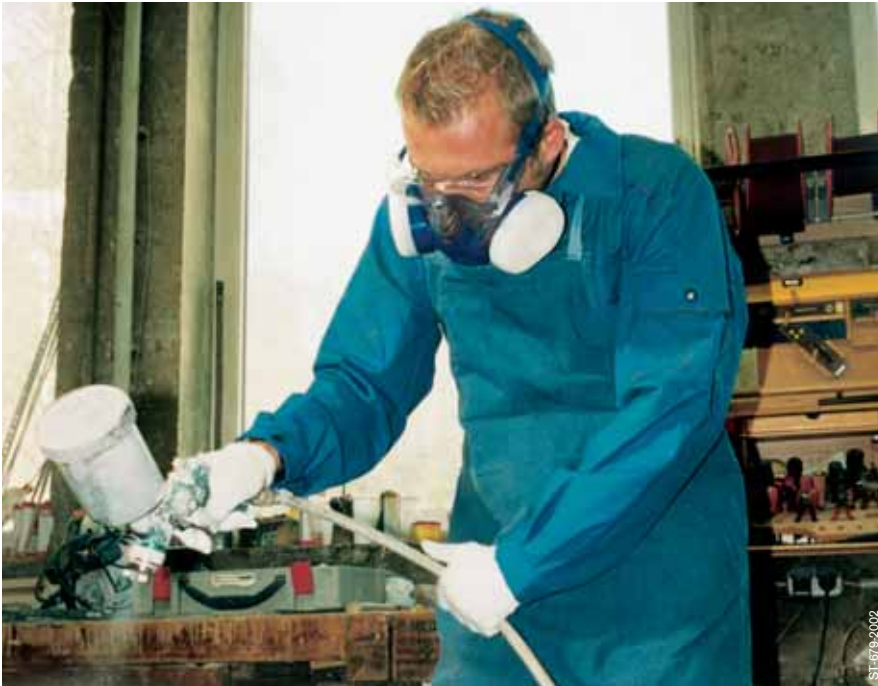
Atemschutzhalbmaske DrägerX-plore 3500 beim Farbspritzen
