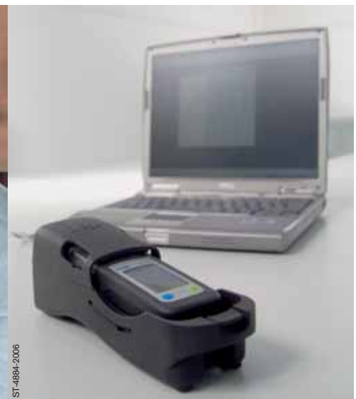
Auslesen des Datenspeichers
